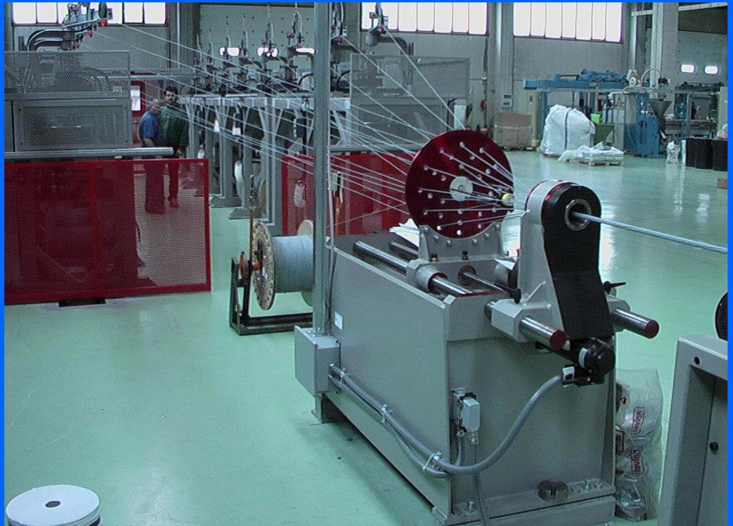
LINEA DE UNION MONOTORSION PARA CABLES ESPECIALES, MICROAXIALES, TULTILAN Y CABLES DE FIBRA OPTICA. LA LINEA ESTÁ COMPUESTA CON UN DESBOBINADORES A DETORSION COMPLETA A 100%, O A SELECCIÓN ,LA DETORSIONE PUEDE SER PROGRAMADA CON PORCENTUALES MAS BAJOS
